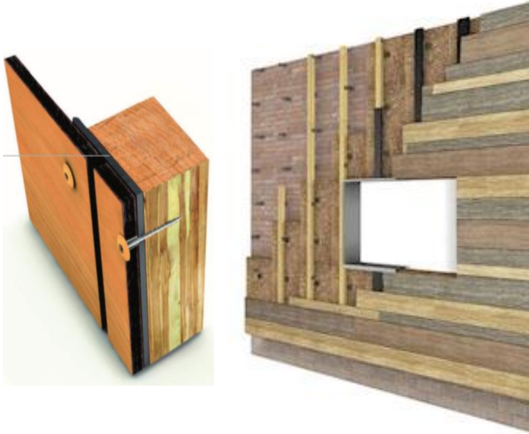
Imagen 2. Ejemplo de detalle constructivo. Fachada ventilada sostenible (S02).
