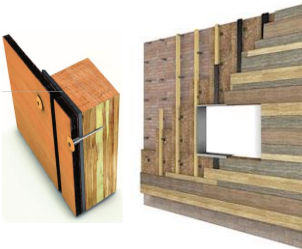
Imagem 2. Exemplo de detalhe de construção. Fachada Ventilada Sustentável (S02).
